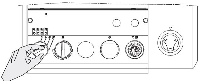
Ruotando la manopola del miscelatore di temperatura dei servizi potete scegliere temperature di erogazione dell'acqua sanitaria che vanno da circa 32° C (posizione min.) a circa 60° C (posizione max.). Sulla manopola sono inoltre indicate 2 posizioni raffigurate con i simboli "奠" e "躺" che corrispondono alle posizioni di normale utilizzo.
