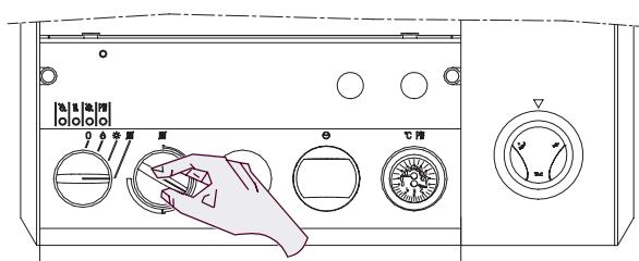
In posizione del simbolo «» (estate) la caldaia Vi darà solo acqua calda sanitaria.
