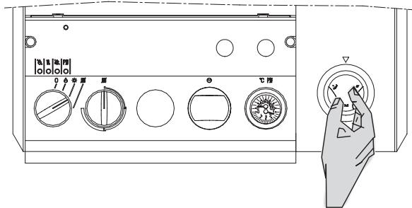
Per lo spegnimento portate il selettore di funzione sul simbolo «0» togliendo tensione alla caldaia, chiudere la manopola del rubinetto del gas posto sotto la caldaia.
